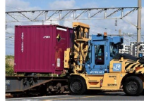
積荷を載せたコンテナはフォークリフトでコンテナ車に積み込まれる。写真：守野玲音
